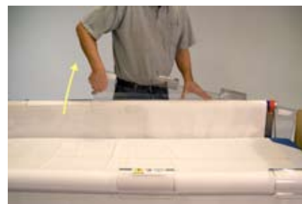
Fjern sengehestene ved at tage fat i siden og hive skråt opad.
